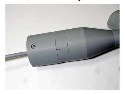
Jetzt setzen wir die beiden Schrauben 3,5 x 16 [8] von unten in den Adapter ein und schrauben sie fest. Damit ist der Rohradapter fest mit dem Anemometer verbunden.
