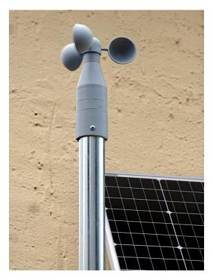
Dazu muss die üblicherweise vorhandene Rohrkappe entfernt werden, damit der Adapter in voller Länge auf das Rohr geschoben werden kann und direkt auf der Rohrkante aufsitzt.
