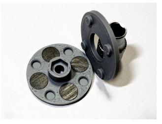
Der Magnet-Halter wird mit 4 Druckknöpfen am Magnet-Teller befestigt. Der Halter wird in die passende Position auf den Teller gelegt und dann Knopf für Knopf zusammengedrückt.
