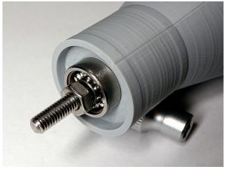
Wir setzen das obere Kugellager in die Anfasung des Sitzes ein und schrauben lose eine M4 Mutter dagegen.
