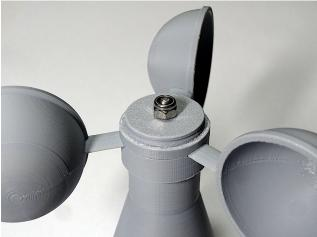
Jetzt verwenden wir einen Schraubenschlüssel um die selbstsichernde Mutter fest zu ziehen – nicht zu fest: sie presst die Plastiknabe auf die obere Kontermutter – soll sie aber nicht zerquetschen. Um die Achse am Wegdrehen zu hindern können wir mit der anderen Hand die Nabe festhalten.
