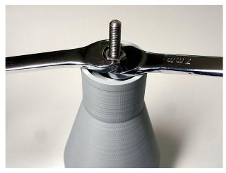
Anschließend werden die beiden Muttern mit zwei Schraubenschlüsseln ordentlich gegeneinander festgedreht (gekontert).
