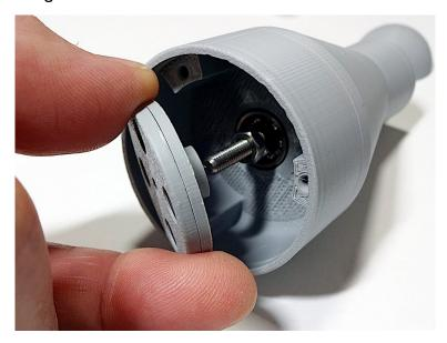
Wenn die Sechskant-Aufnahme vollständig auf die untere Kontermutter geschoben ist, sollte sich der Magnet-Teller frei und rund mit der Achse drehen lassen.
