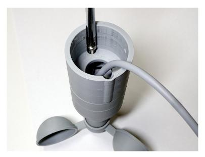
Wir führen das Anschlusskabel durch den Rohrmast und setzen das Anemometer auf das Rohrende auf.
