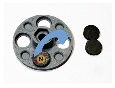
Wir setzen nun diesen Magneten so in das Nachbarfach ein, dass seine Oberseite in diesem Fach unten liegt, seine Oberseite anschließend also "S" ist.
