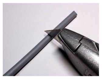
Bei der Verwendung eines Cutter-Messers bitte nicht zu tief einschneiden, um die Litzen-Isolierung nicht zu beschädigen.
