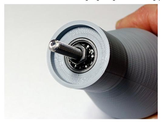
Wir ziehen die Mutter einmal komplett an (nicht mit Gewalt!), bis sich alles sicher gesetzt hat. Die Achse lässt sich dann normalerweise nicht mehr drehen, weil die Distanzhülse gestaucht wird und die Lager verspannt sind.
