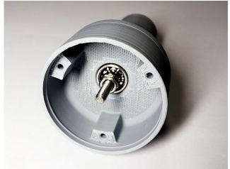
Am oberen Ende schaut jetzt die Achse aus dem oberen Kugellagersitz:
