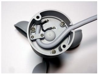
Nun drehen wir die Schrauben soweit an, dass der Kopf jeweils leicht anliegt. Danach drehen wir sie reihum abwechselnd immer stärker an, so dass die Basis in den Schaft einschnappt.
