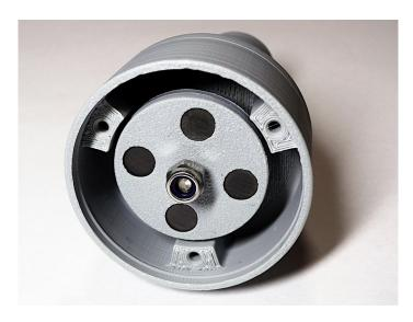
Die Mutter ziehen wir nun mit einem Schraubenschlüssel fest, während wir mit einem zweiten Schraubenschlüssel an der Kontermutter am anderen Ende die Achse am Drehen hindern.
