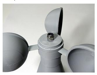
Anschließend setzen wir die zweite selbstsichernde Mutter auf dem oberen Achsende an und schrauben sie zunächst von Hand auf.
