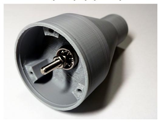
Mit einem möglichst stumpfen Werkzeug, z.B. einem Antriebsgriff für Steckschlüssel, drücken wir das Kugellager vorsichtig und gleichmäßig von allen Seiten in den Presssitz.
