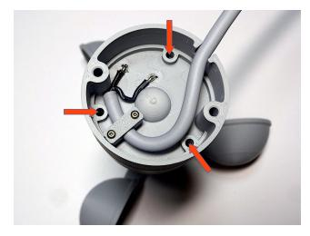
Jetzt setzen wir die 3 Schrauben 2,5 x 16 [9] mit einem Torx-Schraubendreher #8 leicht an, so dass die Position der Basis zum Schaft noch korrigiert werden kann, damit die 3 Schrauben auch wirklich senkrecht stehen und nicht schief eingedreht werden.
