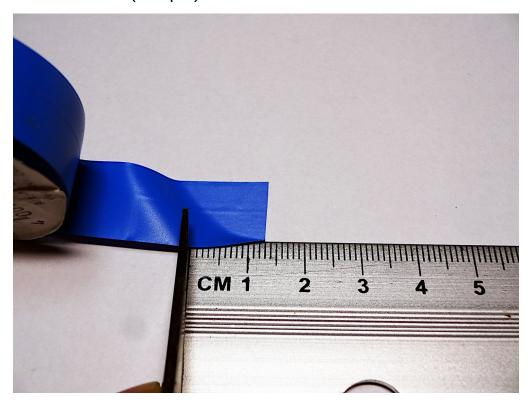
Die Streifen müssen ca. 5 mm breit sein – aus einem 10 mm breiten Klebeband
